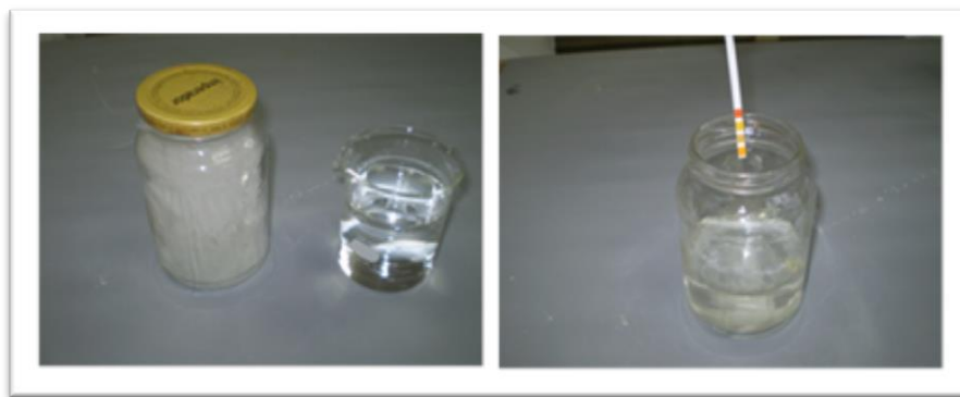
Figura 10 - Simulação da chuva ácida a partir da queima do enxofre em pó e adição de água.
