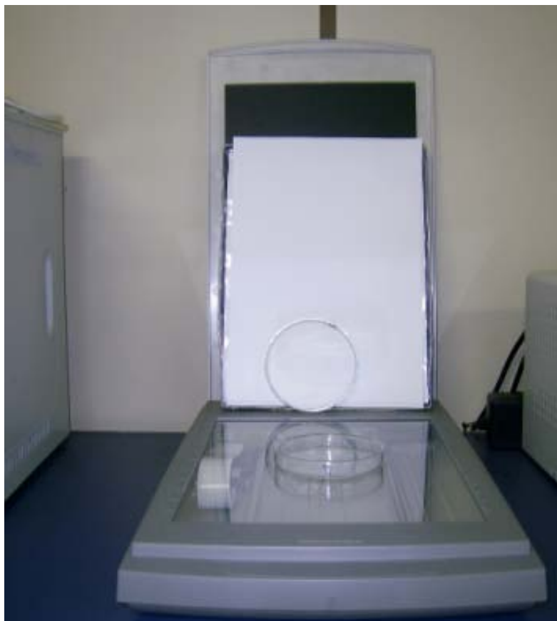
Figura 6- scanner e placa de petri adaptados com anteparos brancos.
