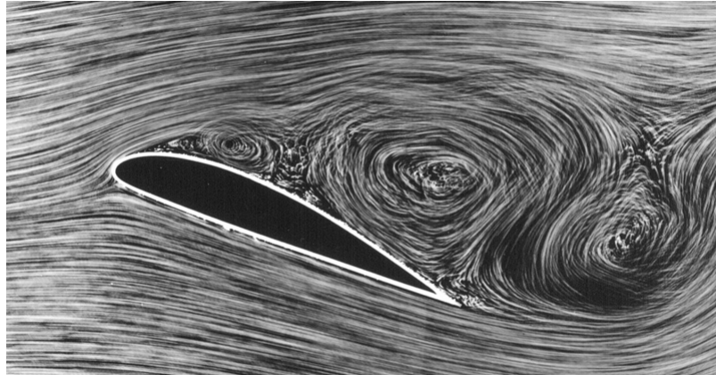
Figura 4: Recirculação de fluxo sobre o perfil. (Fonte: Creative Commons )
