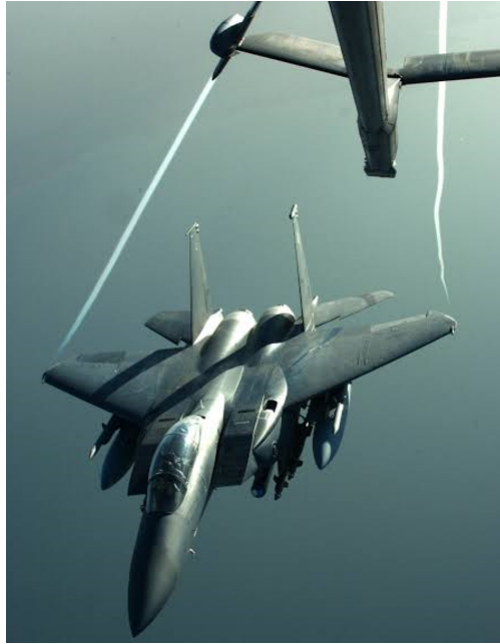
Figura 2: Vórtices de Ponta de Asa.(Fonte: Creative Commons )
