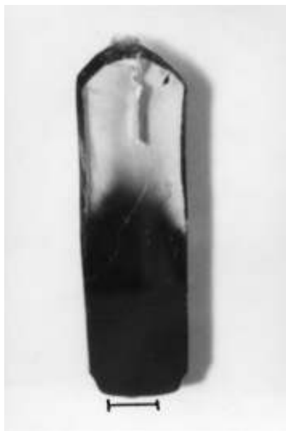
Figura 2.8 - Fatia de cristal crescido por Földvári e colaboradores [3]. A região escura é devida ao fotocromismo resultante da variação da relação Bi/Te ao longo do eixo de crescimento. A marca corresponde a 1 cm.
