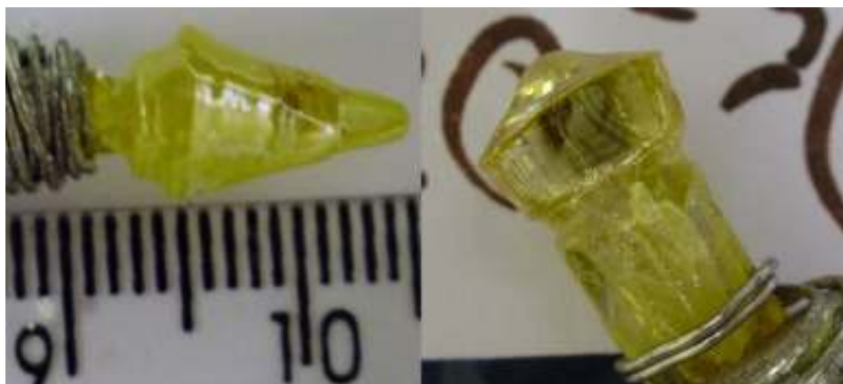
Figura 4.10 - Cristais de \text{Bi}_2\text{TeO}_5 como crescidos. À esquerda, \text{Bi}_2\text{TeO}_5 -021 crescido com velocidade de puxamento de 0,1 mm/h e rotação de 10 rpm; à direita, \text{Bi}_2\text{TeO}_5 -025 crescido com velocidade de puxamento de 0,2 mm/h e rotação de 12 rpm.
