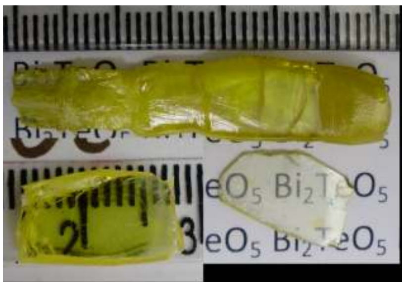
Figura 4.11 - Acima, cristal \text{Bi}_2\text{TeO}_5 -026 crescido com velocidades de puxamento de 0,2 mm/h e rotação de 12 rpm; abaixo, amostras cristalinas obtidas por clivagem e usadas nas medidas ópticas preliminares.
