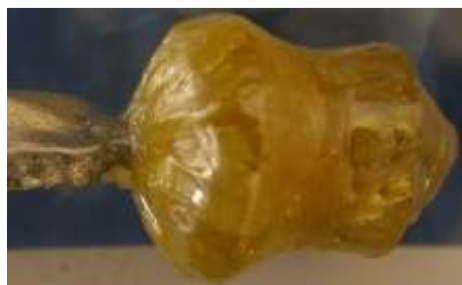
Figura 4.7 - Cristal de \text{Bi}_2\text{TeO}_5 crescido a partir da nucleação em uma chapa dobrada de platina. Usado para produção de sementes.
