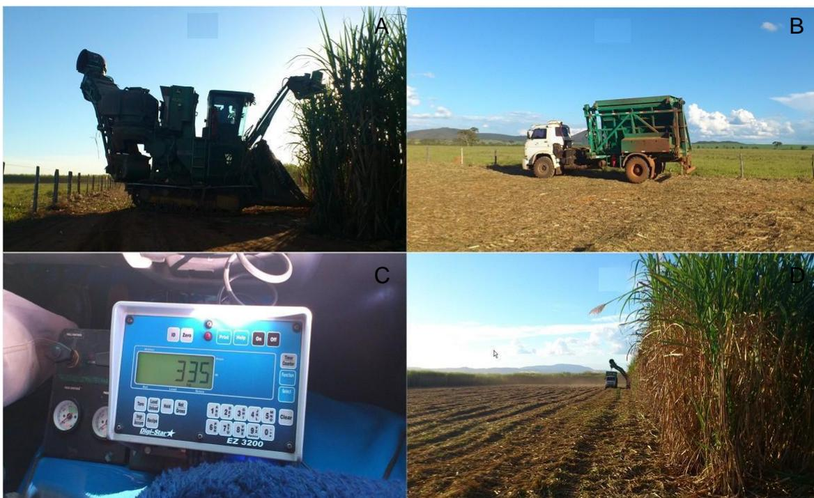
**Figura 11.** Colheita de colmos do experimento. A) Colhedora de cana com esteira rodante marca John Deere modelo 3510; B) Caminhão transbordo com rodado de alta flutuação; C) Célula de carga do caminhão transbordo com o visor posicionado dentro da cabine e; D) Colheita da linha de cana no experimento.
