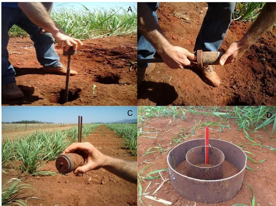
**Figura 4.** Procedimento para retirada de amostra indeformada segundo Camargo (2009). A) Amostrador de Uhland (detalhe martete), B) Amostrador de Uhland (detalhe cilindro), C) Amostrador de Uhland (detalhe anel), D) Determinação da Taxa de Infiltração de água no solo pelo método anel duplo concêntrico.
