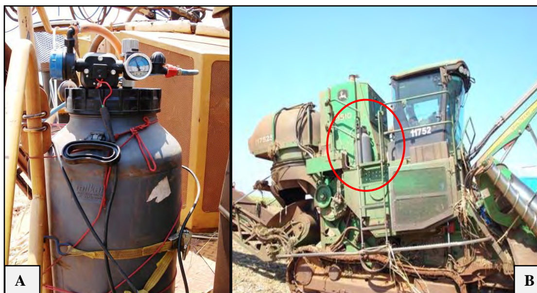
Figura 5. Detalhe do tanque e conjunto de pulverização (A); equipamento completo instalado na colhedora de cana-de-açúcar (B).
