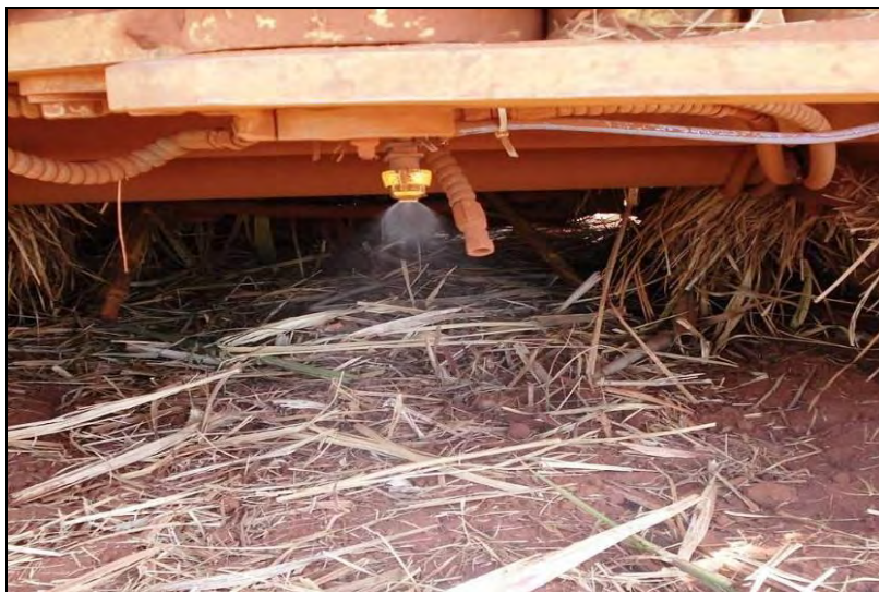
Figura 6. Detalhe do bico de pulverização instalado na colhedora de cana-de-açúcar, antes da deposição da palha sobre a soqueira.
