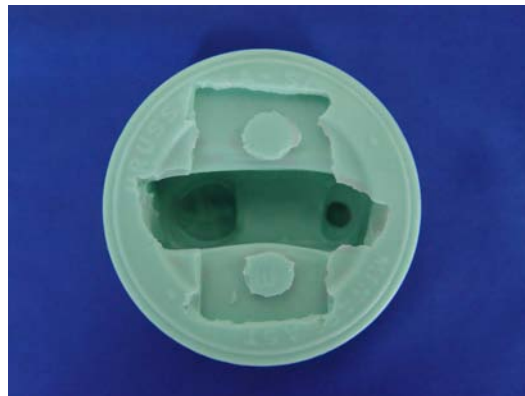
Figura 4.7: Molde obtido com silicone para duplicação do tipo Silicone Master (Talladium do Brasil).
