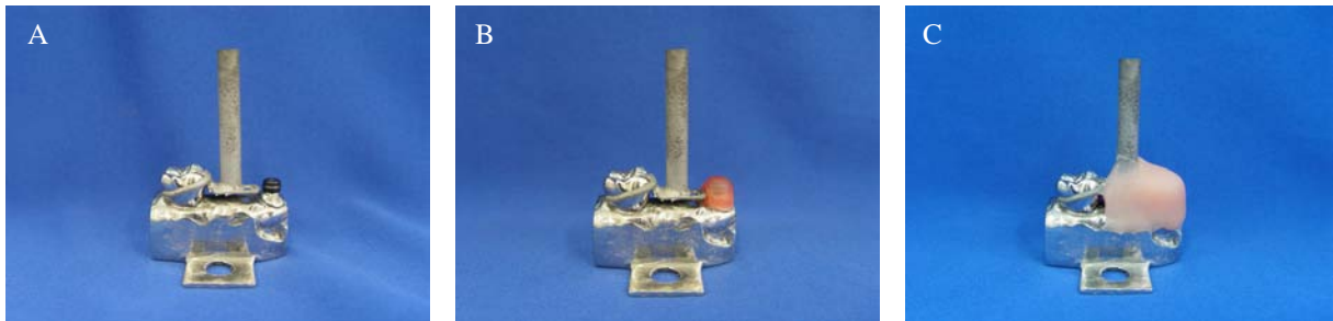
Figura 4.21: A) Avaliação da estrutura com relação a adaptação e estabilidade sobre a matriz metálica. Macho de processamento de cor preta encaixado sobre a fêmea do sistema ERA®. B) Alívio em cera sobre os componentes do sistema ERA®. C) Corpo de prova com a base protética.
