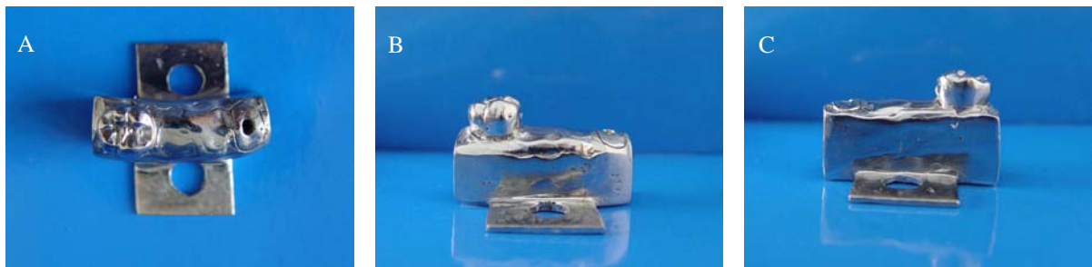
Figura 4.1: A) Vista oclusal da matriz representativa da hemi-arcada inferior direita. B) Vista vestibular da matriz com contorno retentivo de 0,25mm. C) Vista lingual da matriz.
