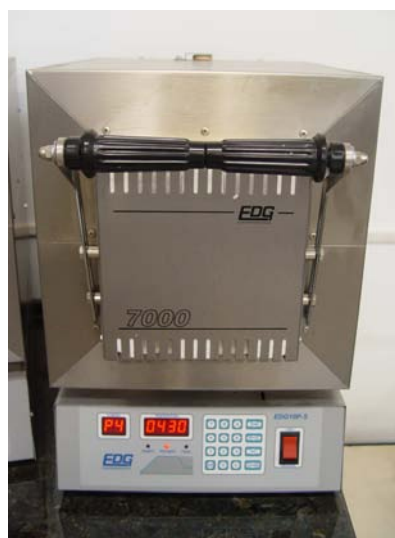
Figura 4.9: Forno EDG 7000 utilizado para o tratamento térmico dos modelos refratários.
