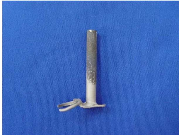
Figura 4.20: Corpo de prova em Ti cp após polimento químico.
