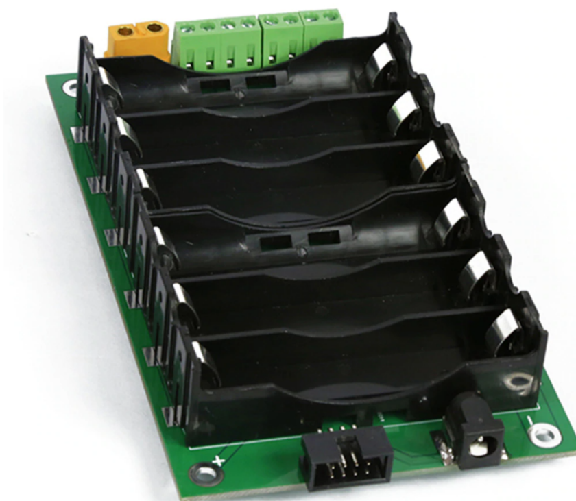
Figura 4.2 – Módulo de armazenamento e carregamento de baterias.
