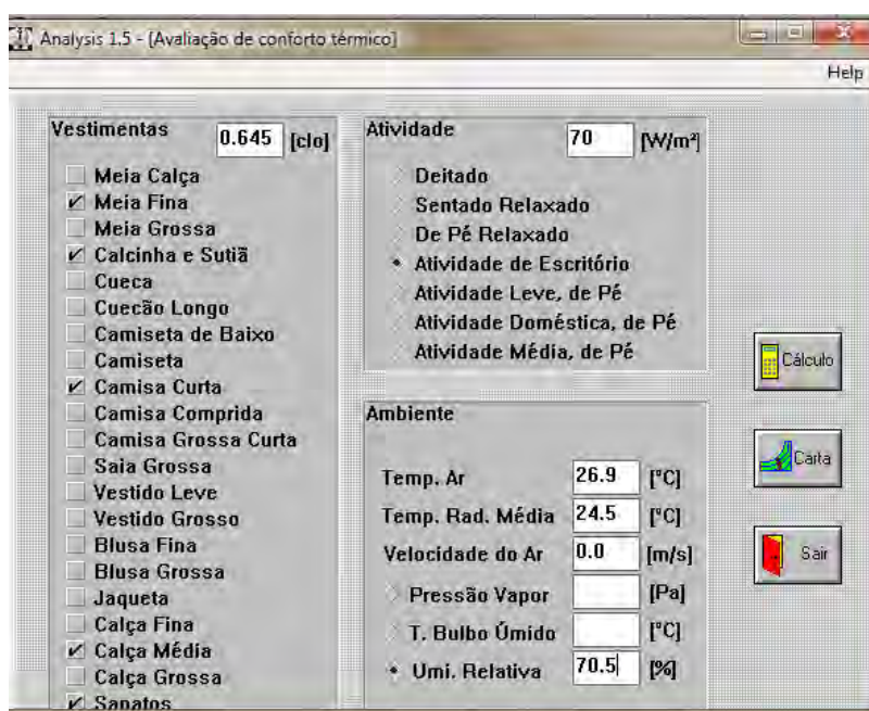
Figura 5.17: Tela do programa Analysis 1.5 com os dados para o cálculo do PMV e do PPD.
