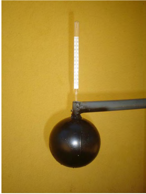
Foto 4.9 À esquerda termômetro de bulbo seco inserido no globo negro. À direita detalhe do termômetro de bulbo seco.
