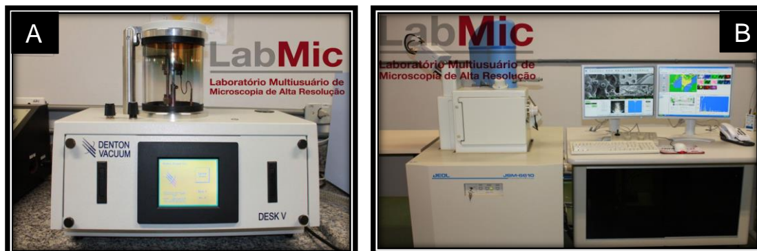
Figura 11. Vista panorâmica do sistema para deposição de filmes de ouro, Denton Vacuum, Desk V (Morristown; New Jersey, USA) equipado com acessório de carbono (Figura 11A) e Microscópio Eletrônico de Varredura (MEV), (JEOL, JSM – 6610, Tokyo, Japão) (Figura 11B). Goiânia, 2019. Fonte: https://www.labmic.ufg.br/n/45787 - Laboratório Multiusuário de Microscopia de Alta Resolução da Universidade Federal de Goiás (LabMic/ UFG).
