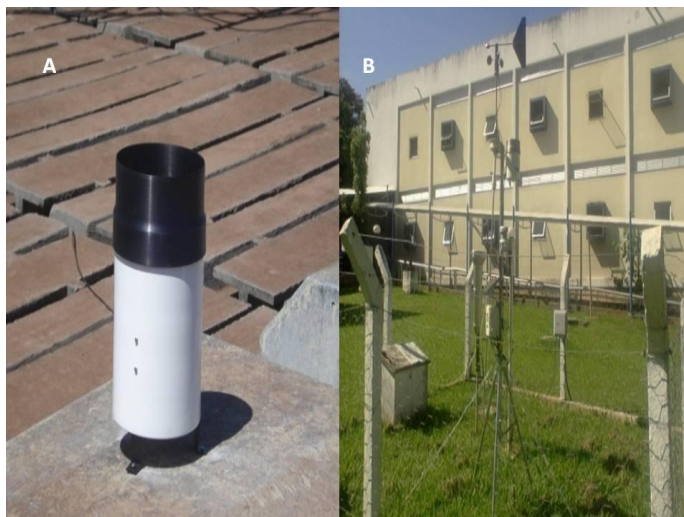
Figura 22. Pluviógrafos. (A) Data logger do Rainfall Sensor Onsetcomp e (B) Pluviógrafo da EEC - UFG (BARBALHO, 2012).
