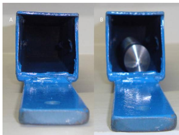
Figura 17. Estrutura para fixação em gabião. (A) Vista interna sem linígrafo e (B) Vista interna com linígrafo.
