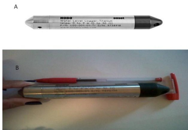
Figura 18. Linígrafos utilizados em campo. (A) HOBOWare e (B) medida do linígrafo (OLIVEIRA, 2012).
