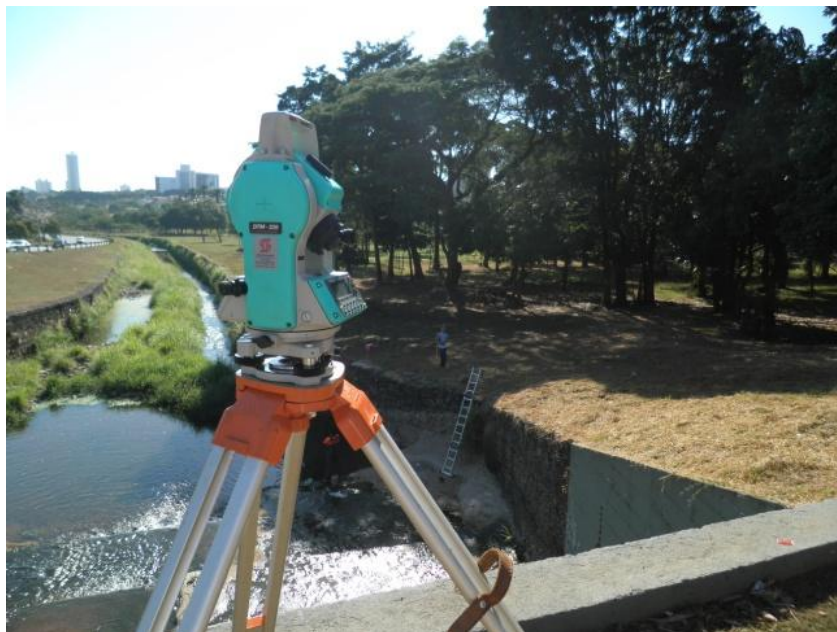
Figura 12. Levantamento Planialtimétrico – estação total (OLIVEIRA, 2012).
