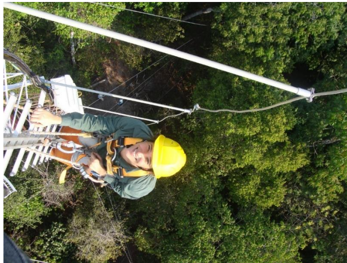
Figura 1: Torre que mede trocas de carbono da floresta com a atmosfera instalada na Fazenda Tanguro.
