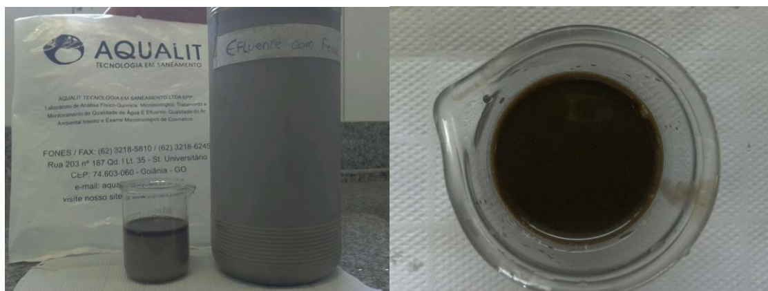
Figura 9: efluente coletado em posto de combustível, com contaminação confirmada de fenóis 4ppm.
