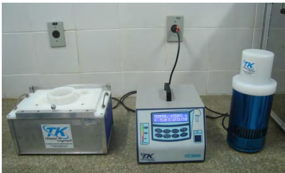
FIGURA 2 - Aparelho TK 3000 utilizado para a criopreservação das amostras de sêmen
