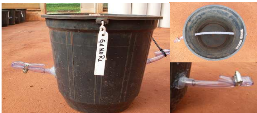
Figura 4.1. Sistema de coleta de solução do solo em vaso, com detalhe da mangueira perfurada.
